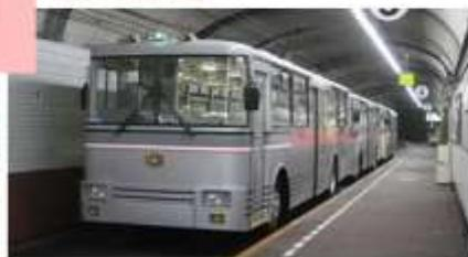
開電隧道無軌電車是建設黑部大壠時為了運送建築材料而挖掘的隧道中行使的無軌電車。
